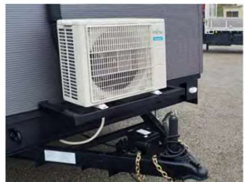
⑪エアコン等の室外機がトレーラーハウスの積載されていること。
