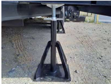
②車輪以外の物で地上に支持されている場合、その支持構造体が工具無しで取り外しができること。
